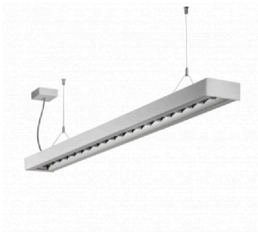
ZULI Direkt/Indirekt Suspendant · 1145 mm × 125 mm × 50 mm · Matter Parabolraster
